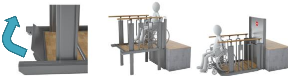
1: Die Rampe hebt und verriegelt sich. 2: Fahren Sie auf die Plattform. 3: Fahren Sie von der Plattform.
