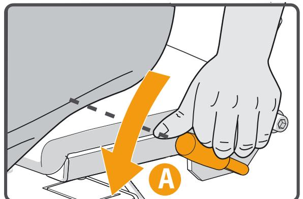
Der Lift stoppt automatisch am Schienenende. Sie können den Sitz nun von Hand drehen, damit Sie bequemer aufstehen und wieder Platz nehmen können. Drücken Sie dazu den Hebel nach unten {A}. Drehen Sie den Sitz, bis Sie ein Klickgeräusch hören. Der Sitz befindet sich jetzt in der richtigen Position {B}.
