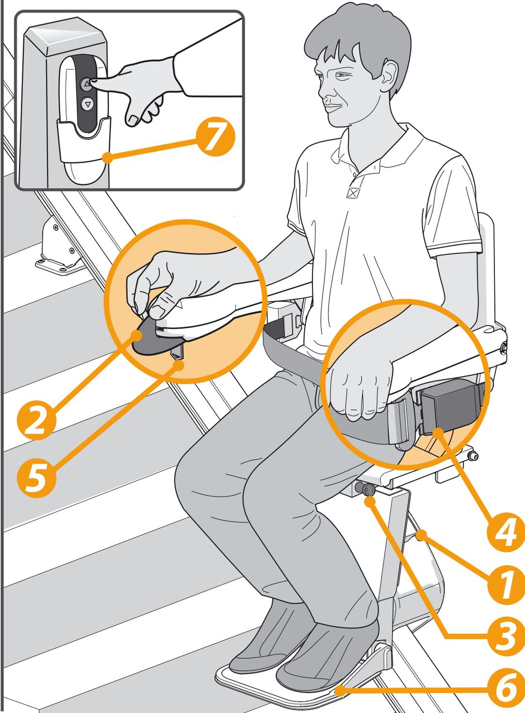
Die obenstehende Illustration zeigt die Elemente, mit denen Sie den STYLE Sitz bedienen. Um den Sitzkomfort und die Bedienungsfreundlichkeit zu erhöhen, können Sie den STYLE Sitz um folgende Optionen erweitern: automatischer Drehsitz, der automatische Fußstütze.
