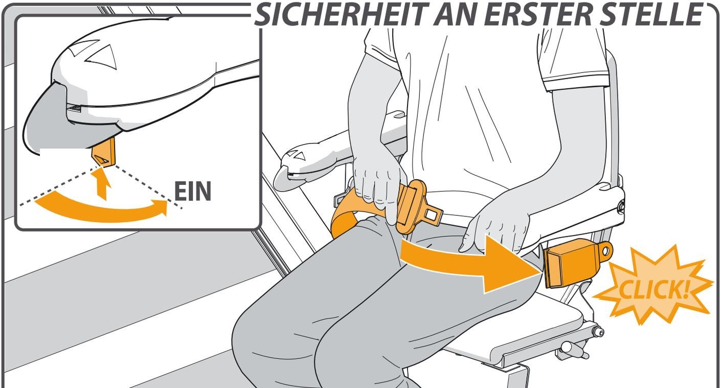
Legen Sie den Sicherheitsgurt an und klicken Sie diesen gut in der Halterung fest. Stecken Sie den Schlüssel in den Kontakt und drehen Sie diesen eine Vierteldrehung nach rechts. Prüfen Sie, ob der Sitz verriegelt ist.
