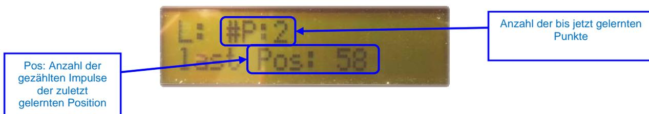
Mit der Aktivierung der Lernfahrt werden automatisch zwei Punkte gelernt, die Position der unteren Haltestelle und eine temporäre Position unterhalb. Deshalb steht #P:2 am Display. Der Wert von last Position muss ungleich Null sein und deren Größe hängt von der eingestellten Übersetzung ab.
