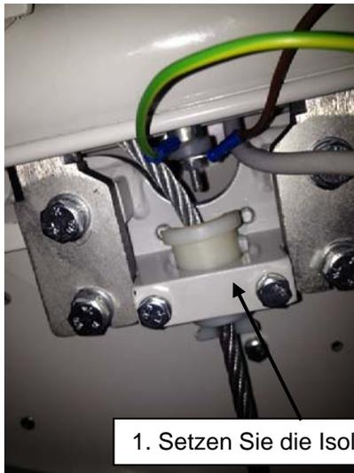
1. Setzen Sie die Isolationstücke aus Plastik ein
