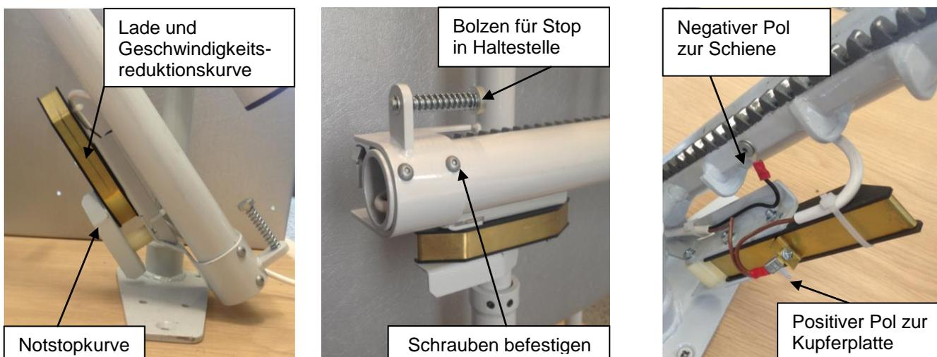
An schrägen Schienenelementen wird die elektrische Erdung auf die Zahnstange übertragen. Bei Horizontalfahrten kann diese Erdungsverbindung unstabil sein. Daher ist bei horizontalen Endhaltestellen oder Zwischenhaltestellen wichtig, eine Kupferplatte auf das obere Rohr zu befestigen. Diese Kupferplatte stellt sicher, dass die elektrische Erdung gegeben ist.
