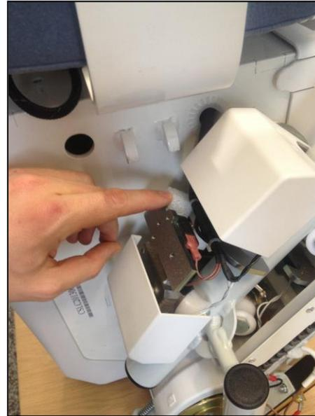
Der Hebel wird durch die Schienen aktiviert. Wenn der Lift in eine Kurve fährt, wird der Hebel durch die Schiene angedrückt und der Geschwindigkeitsreduktionsschalter aktiviert. Wird dieser Schalter nicht aktiviert, biegen Sie den Hebel ein wenig, damit der Druck in den Kurven erhöht wird. Passen Sie aber darauf auf, dass Sie den Hebel nicht zu stark biegen, sonst fährt der Lift auch auf geraden Strecken langsam.
