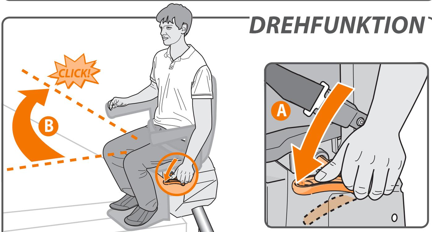
Der Lift stoppt automatisch am Schienenende. Sie können den Sitz nun von Hand drehen, damit Sie bequemer aufstehen und wieder Platz nehmen können. Drücken Sie dazu den Hebel nach unten {A}. Drehen Sie den Sitz, bis Sie ein Klickgeräusch hören. Der Sitz befindet sich jetzt in der richtigen Position {B}.
